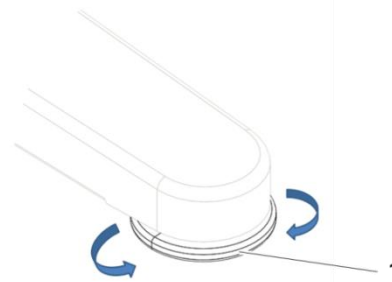
Figure 4-2 : mise à niveau en hauteur Migration SE (Figure avec l'exemple « Ology Desk »)
